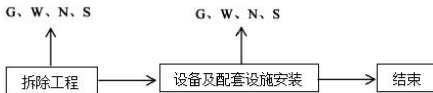
图 2-3 施工期施工工艺及产污环节图
